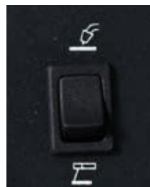
Dy mode saldimit MIG/MAG dhe me elektroda
