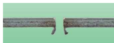
Për krahasim: Formimi i vargës tek disqet e rëndomta 1,0-mm- të tregut.
