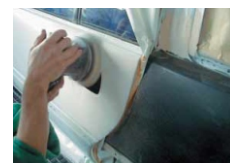
Lëmuarje e mbushjes me Useit® Superdisk P AM, Granulacioni 100.
