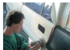
Lëmuarje e kitit me Useit® Superdisk P AM, Granulacioni 100.
